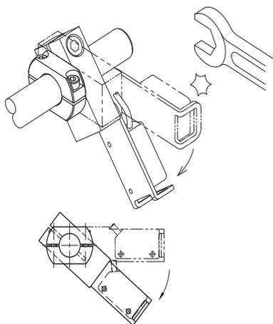
位置再現ブラケットの基準面を目安に固定し直せば、簡単にセンサを元の位置に戻せます
