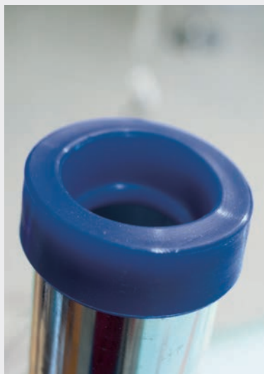
パイプ端部のマスキング
