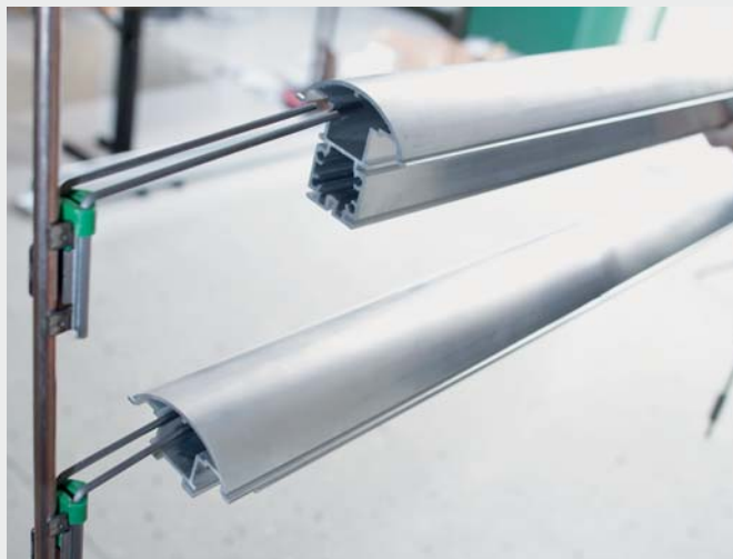
ヨークインサートBHS150x4,0F93を使ったプロファイルの吊り下げ
