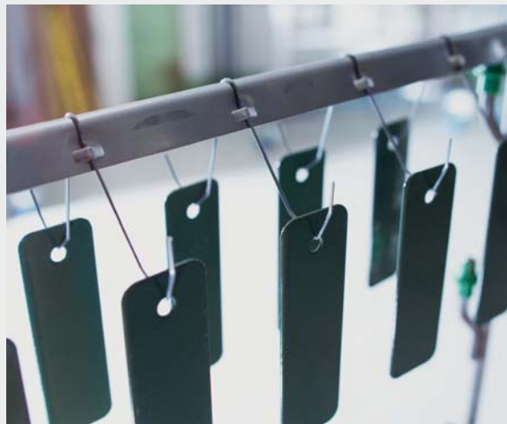
ワークの脱落を防ぐトリプルアングルの特注フック
