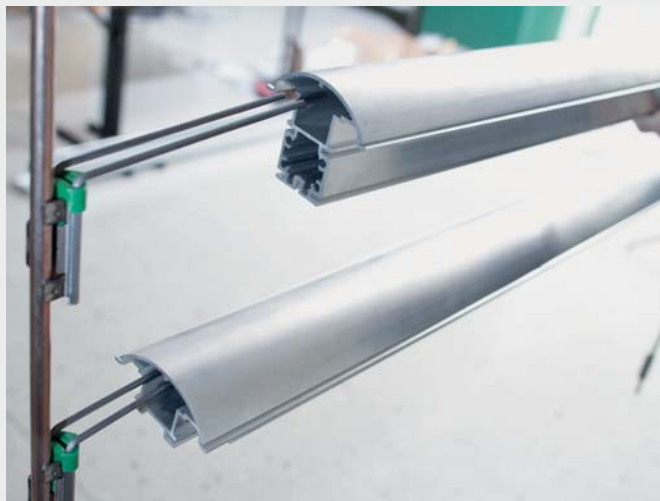
ヨークインサートBHS150x4,0F93を使ったプロファイルの吊り下げ
