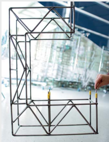
重量ワーク用治具（接点交換式）
