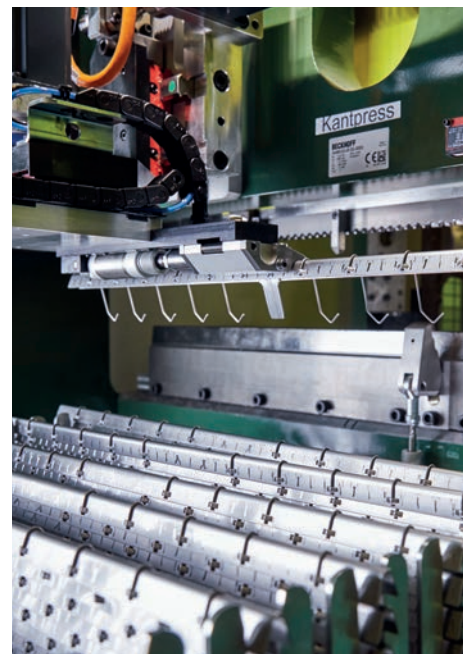
HQCを製造する、3つの部品を組み付ける専用機
